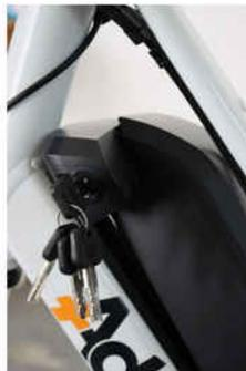
figure 9- Enclenchement de la batterie sur son socle
