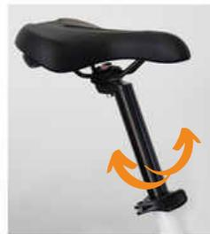
figure 12- Levier de réglage de la hauteur de selle
