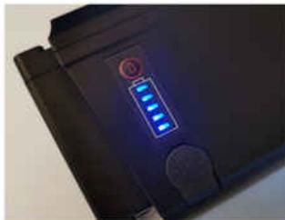
figure 10- Témoin de charge de la batterie
